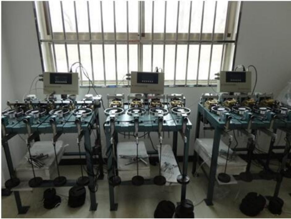
图为四联电动直剪仪，业内最先进的直剪仪，用于土工试验中土的剪切指标的测定。
