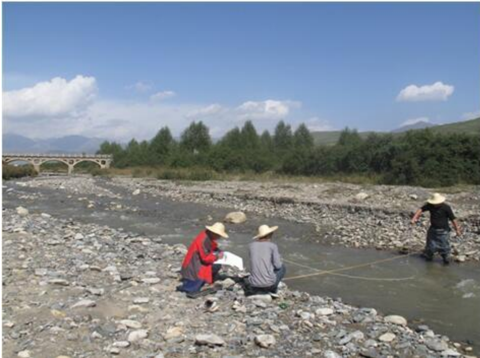
顶岗实习基地满足学生水文地质勘察中各种工作内容的训练，图为学生测量流量。
